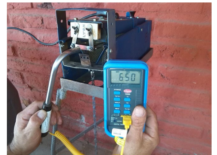
使用超高温温度计来测量刀片温度，需达到650°C左右
