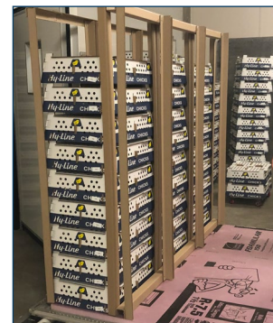
Las paletas de envío para huevos fértiles están construidas con espaciadores preformados que brindan resistencia y espacio de aire alrededor de las cajas de pollitas.
